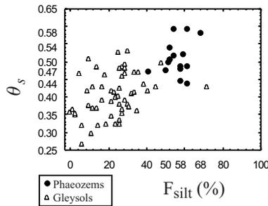
Fig. 10.  $\theta_s$  parameter versus silt content.
